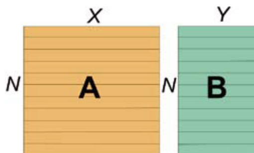
Rys. 1. A ( N \times X ) – macierz zmiennych niezależnych (wielkości wejściowych), gdzie N – liczba badanych rodzajów podłoży, X – liczba niezależnych zmiennych (parametrów podłoża). B ( N \times Y ) – macierz zmiennych zależnych, gdzie Y – liczba parametrów jakościowych nadruku (wielkości wyjściowych).
