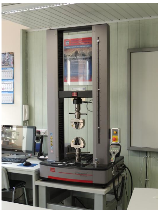
Komputerowo wspomagane stanowisko do badania własności mechanicznych materiałów
