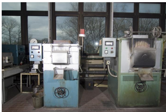
Laboratorium obróbki cieplnej- piece komorowe
