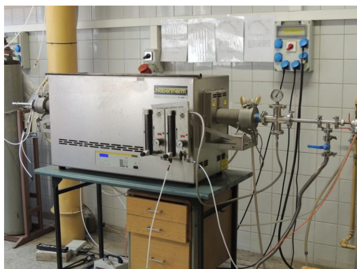
Laboratorium metalurgii proszków – stanowisko do spiekania próbek w kontrolowanej atmosferze
