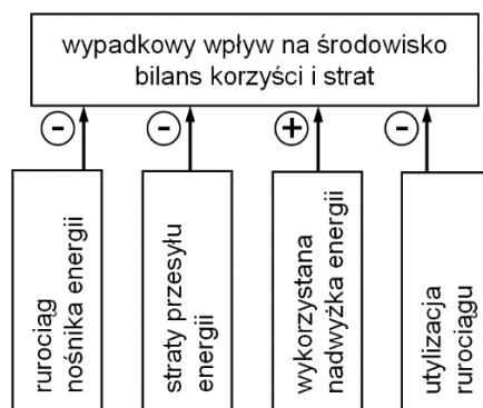
Rys. 2. Struktura modelu badań wpływu na środowisko wykorzystania nadwyżki energii cieplnej źródło: [3, s. 51]
