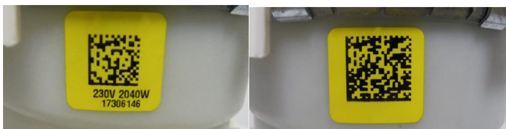
Rys. 9. Widok etykiety oryginalnej (po lewej) i zmodyfikowanej – zawierającej dodatkowe dane o składzie materiałowym (po prawej)
